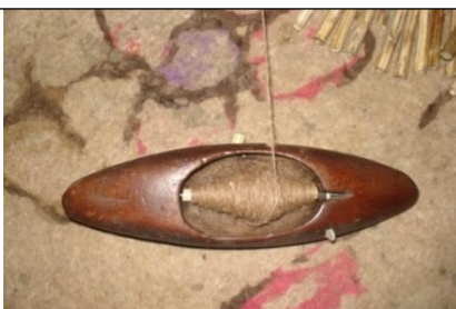
ماکو با نیچه نخ پر شده که نخ را در میان تارهای کارگاه میرساند.
